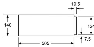
Über eine Wärmeschublade können Kompakt-Backöfen mit einer Gerätehöhe von 455 mm eingebaut werden. Ein Zwischenboden ist nicht erforderlich.
