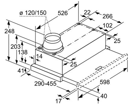
Tiefenanpassung des Filterauszuges bis 29 mm möglich
