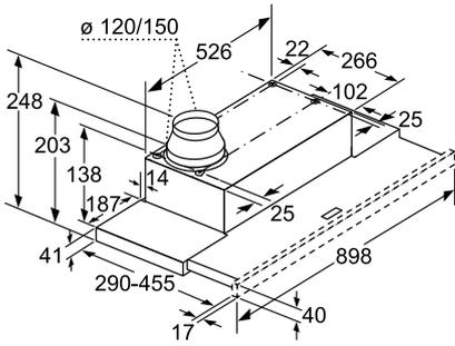
Tiefenanpassung des Filterauszuges bis 29 mm möglich
