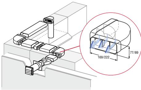
COMPAIR flow 125/150 System mit Leitkörper-Technologie
