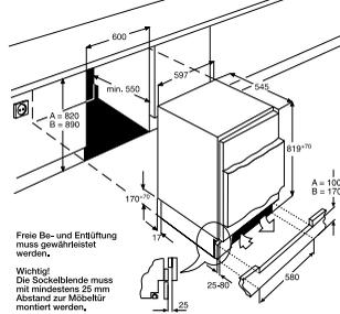
Freie Be- und Entlüftung muss gewährleistet werden.
