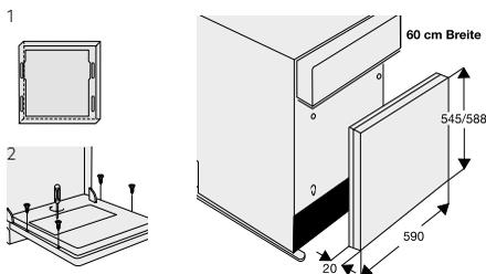
Stufenlose Anpassung an die unterschiedlichen Küchenmöbel-Sockelhöhen durch verstellbare Ausgleichsblendenstücke, die allen integrierbaren Unterbau-Geschirrspülern 60 cm beiliegen.
