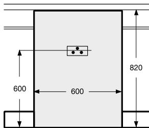
Elektroanschluss bei Unterschrank
