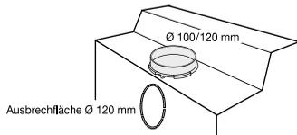
Die Inselhauben sind aufgrund des flexiblen Traggerüsts teleskopierbar. Die Konstruktion des Gerüsts ermöglicht seitlichen Abluftabgang (siehe Maßbilder), wobei für den Kaminausschnitt selbst zu sorgen ist (Sonderanfertigung nicht möglich). Die Deckenmontage ist mit Schablone und am Flansch angebrachten „Schlüssellochern“ denkbar einfach.
