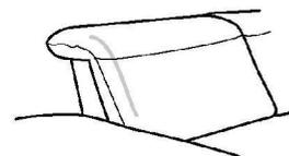
einzeln verstellbare Kopfpolster auf Führungsschienen gelagert mit Faltenoptimierung
